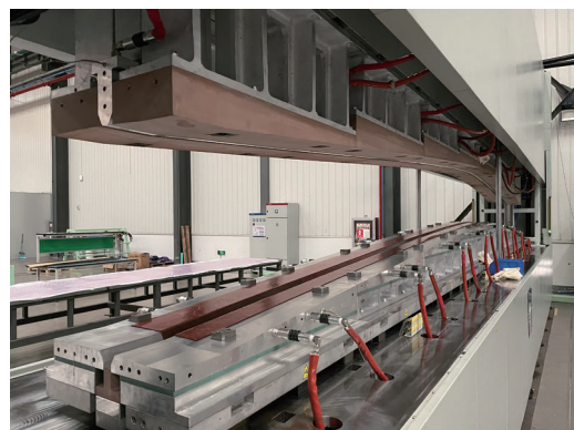
图 15 双曲帽型长桁预成型体制造
